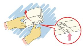
●フィルター押さえを曲げながら外しフィルターを取り出します。
